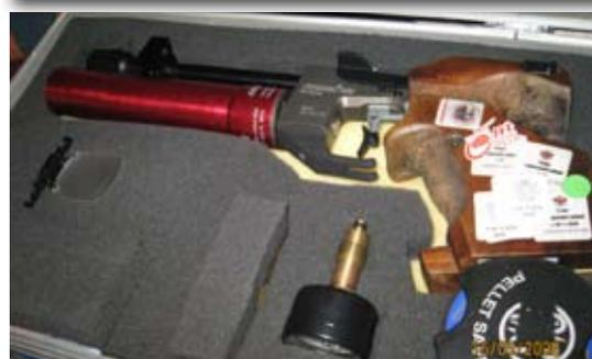
Die Luftpistole besteht aus einer Kartusche mit gepresster Luft und kleinen kelchförmigen Bleikugeln mit einer Öffnung auf der Unterseite, durch die die Luft in die Kugel gepresst wird.
